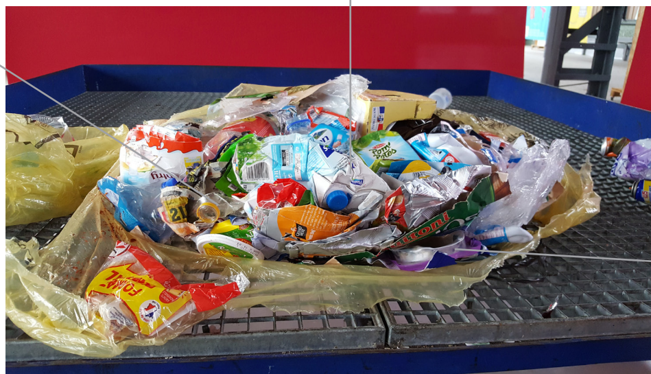
2. Chaque sac est déposé sur une table de tri. Les déchets sont alors triés manuellement par un opérateur.
